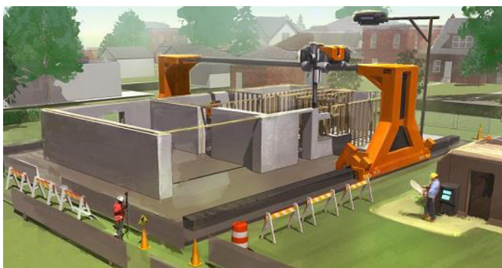
Рис. 5 Конструктивное исполнение строительного 3D-принтера
