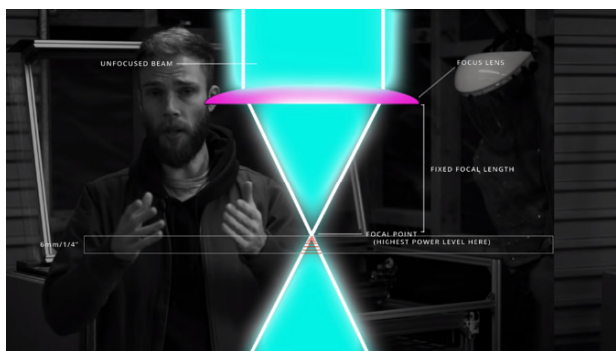
Рис. 5. Фокус лазерного променя
