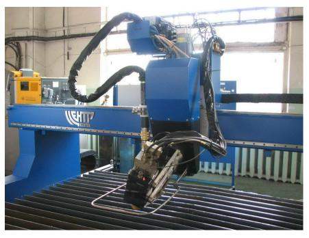
Puc. 1. Технологический комплекс плазменного раскроя материала с манипулятором для резки и разделки кромок заготовок под углом
