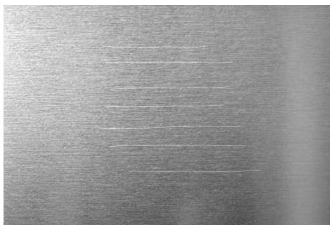
Рисунок 1 – Поверхность металла с дефектами в виде царапин
