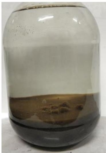
Рисунок 1 – Преципитат после отстаивания его в течение 24 часов в натриевой щелочи
