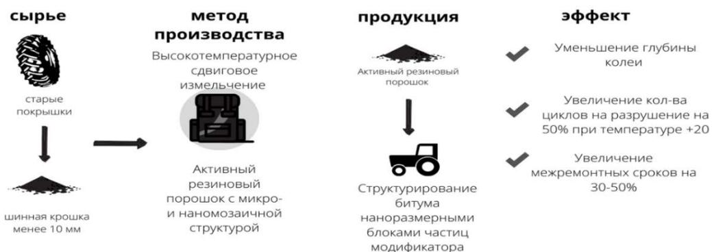
Рисунок 2 – Модификатор – активный резиновый порошок с микро- и наномозаичной структурой
