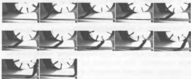
Рис. 3. Раскадровка видеосъемки однократного акта воздействия лопасти массажера с поверхностью упругого основания при частоте ее вращения 90 мин -1
