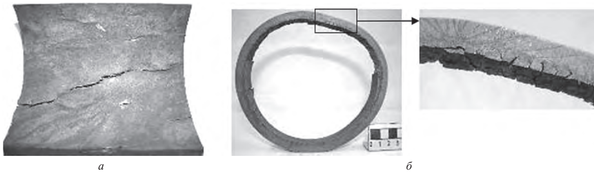
Рис. 6. Внешний вид расслоений по осевому пережогу (стрелкой показан дефект в увеличенном виде): a – внутренняя поверхность гильзы; б – макроструктура
