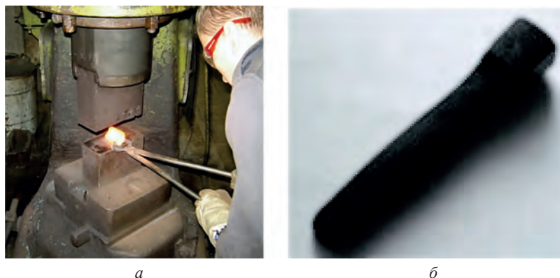
Рис. 2. Получение опытных образцов с применением высокотемпературной термомеханической обработки: а – процесс деформации заготовки на пневматическом ковочном молоте; б – образец заготовки, полученной при ковке
