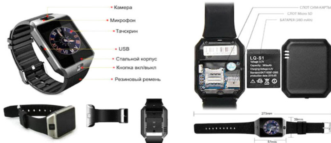
Рисунок 1 – Внешний вид и устройство смарт-часов
