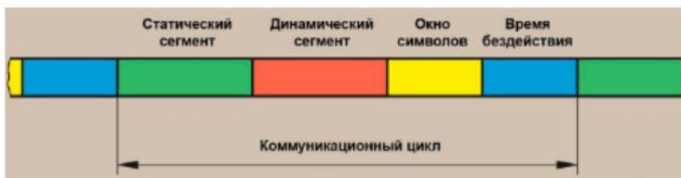
Статический сегмент служит для передачи пользовательских данных между компонентами шины. Он разделён на постоянные временные интервалы, называемые слотами. Число слотов задается производителем автомобиля, однако максимальное их число не может превышать 1023. Во время каждого слота передавать данные может только одно определённое устройство шины. Но принимать данные, передаваемые в статических слотах, могут все участники шины.
