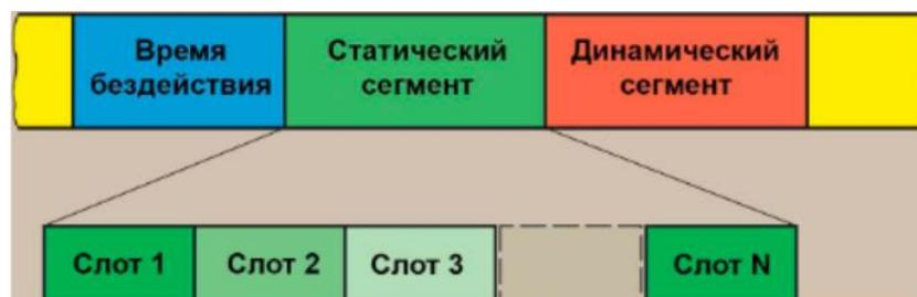
Принципиальной чертой протокола является то, что вся структура слотов статического сегмента в каждом цикле всегда воспроизводится полностью. В статическом сегменте передаются главным образом данные, критически важные для безопасности.
