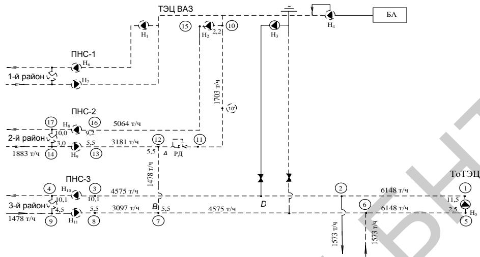
Рис. 4. Исходные данные и результаты расчетов гидравлического режима при существующей нагрузке: ①, ②... – номер точек; цифры при точках – давление, кгс/см<sup>2</sup>
