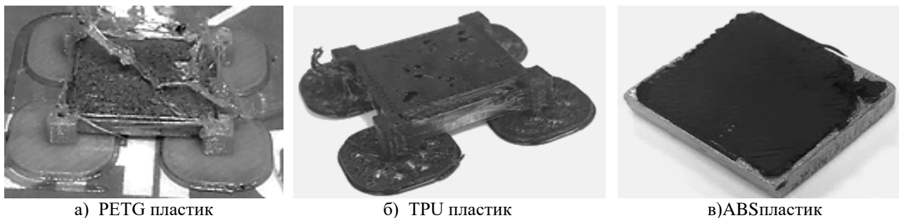
Рисунок 2 – Внешний вид образцов с нанесенными методом 3D печати полимерами разного состава
