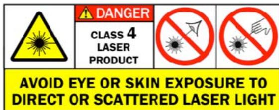
Рис. 3.50. Пример обозначения прибора, содержащего лазер 4-го класса опасности
