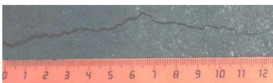
Рисунок – Зафиксированная трещина в плите
