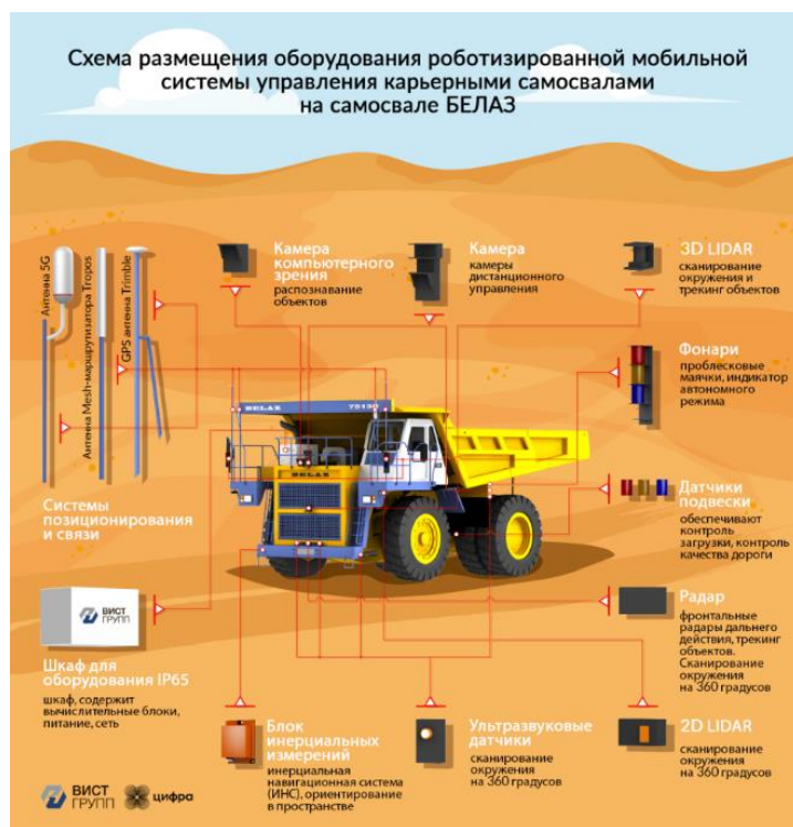
Рис. 1. Схема размещения оборудования на самосвале «БелАЗ-75137R»
