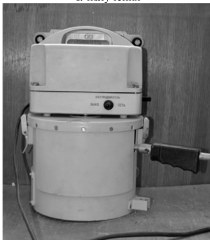
Рис. 3.2. Блок детектирования \alpha -излучения
