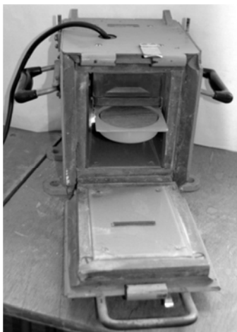
Рис. 3.3. Блок детектирования \beta -излучения
