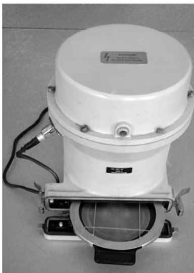
Рис. 3.2. Блок детектирования \alpha -излучения
