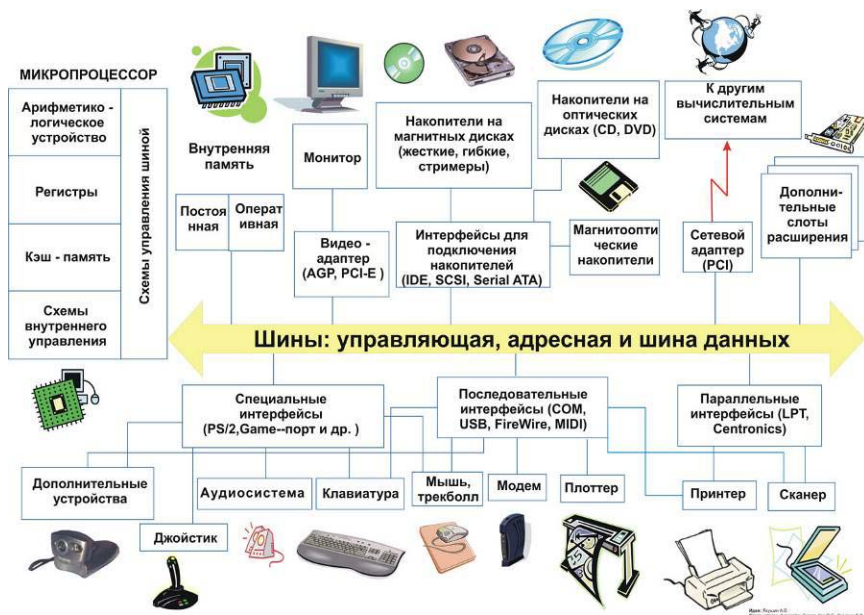
Рис. 2.3. Структурная схема ПК [http://lanusic2008.narod.ru/labor.files/img0202.jpg]
