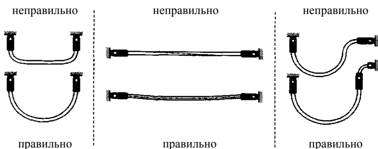
Рис. 1.3. Рекомендации по монтажу гибких трубопроводов
