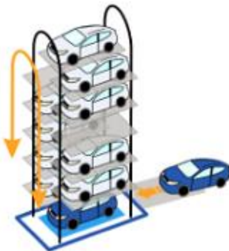
Рисунок 2 – Роторная автоматизированная парковка
