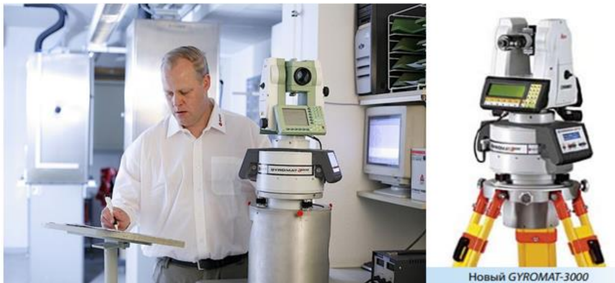
Рисунок 2 – GYROMAT-3000 (полностью автоматический гироскоп для геодезического применения)
