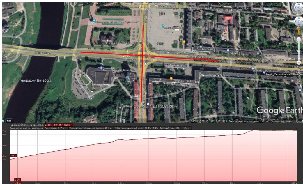
Рисунок 2 – Продольный профиль местности
