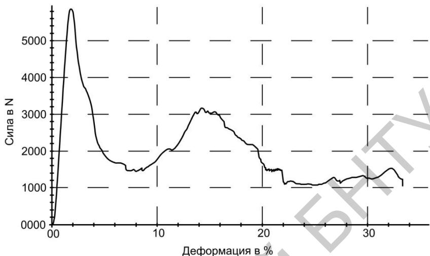
Рисунок 2 – Зависимость сжимающей силы от деформации образца
