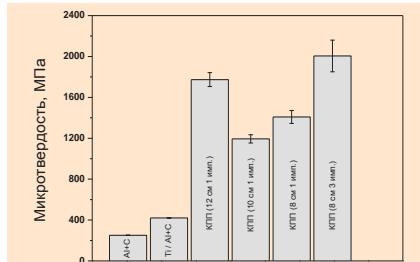
Рисунок 1 – Микротвердность после обработки
