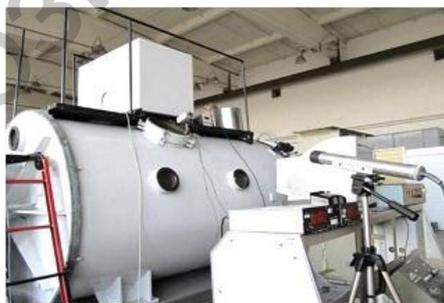
Рисунок 3 – Установка электронно-лучевой обработки
