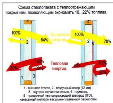
Рисунок 2 – Схема стеклопакета с теплоотражающим покрытием
