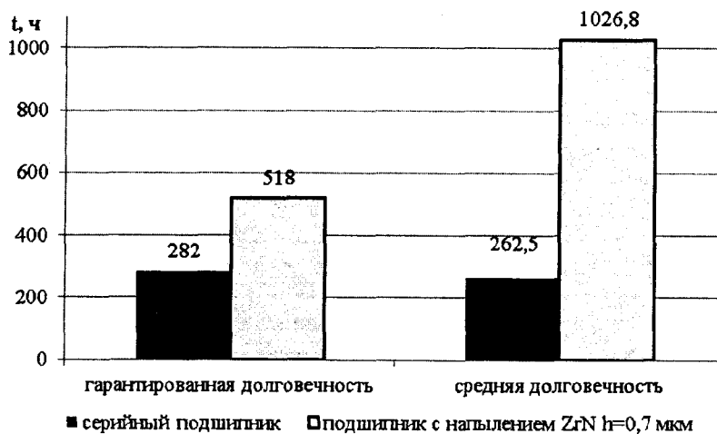
Рис. 3. Диаграммы гарантированной и средней долговечности для серийных и упрочненных шариковых подшипников 6305
