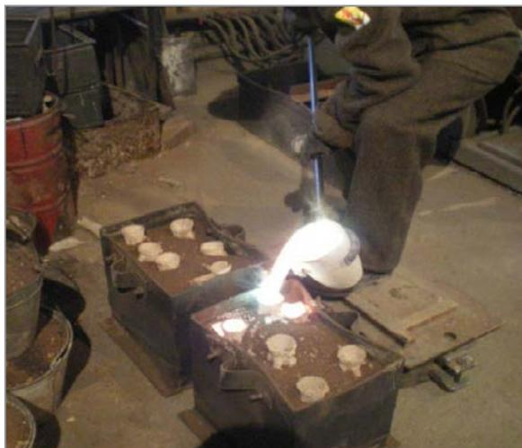
Рис. 8. Заливка форм
