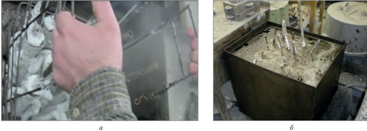
Рис. 7. Операция удаления модельного состава из формы:
