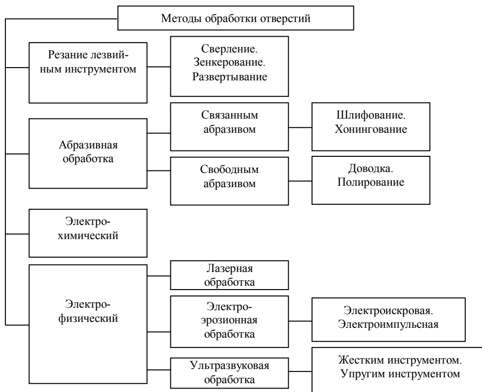
Рис. 2. Методы обработки отверстий
